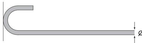
**Figure n° 12 : ancrage courbe.**
