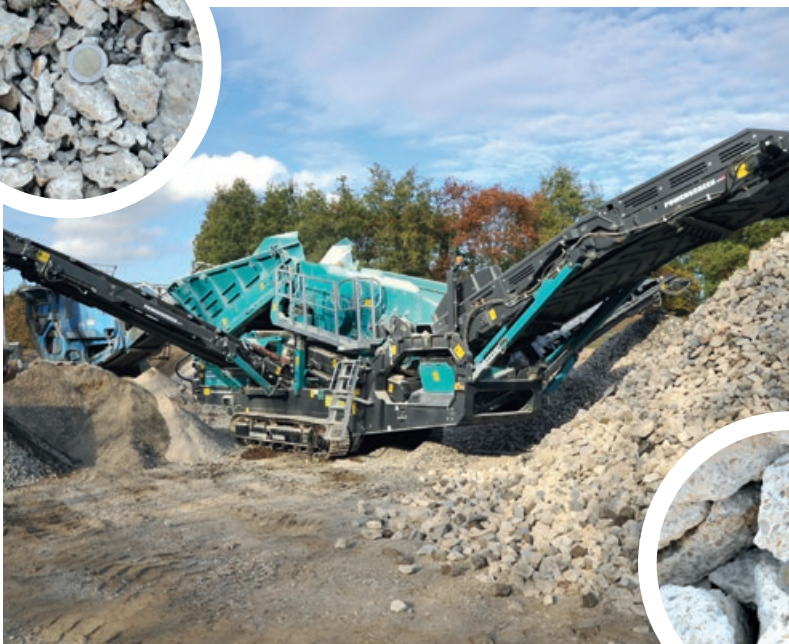
Le concasseur mobile en action. En médaillons : les granulats obtenus par concassage.
