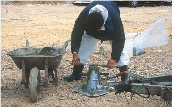
Mesures d'affaissement au cône d'Abrams.
