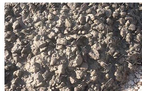
Un béton prêt à l'emploi comportant 45 kg/m<sup>3</sup> de fibres métalliques.
