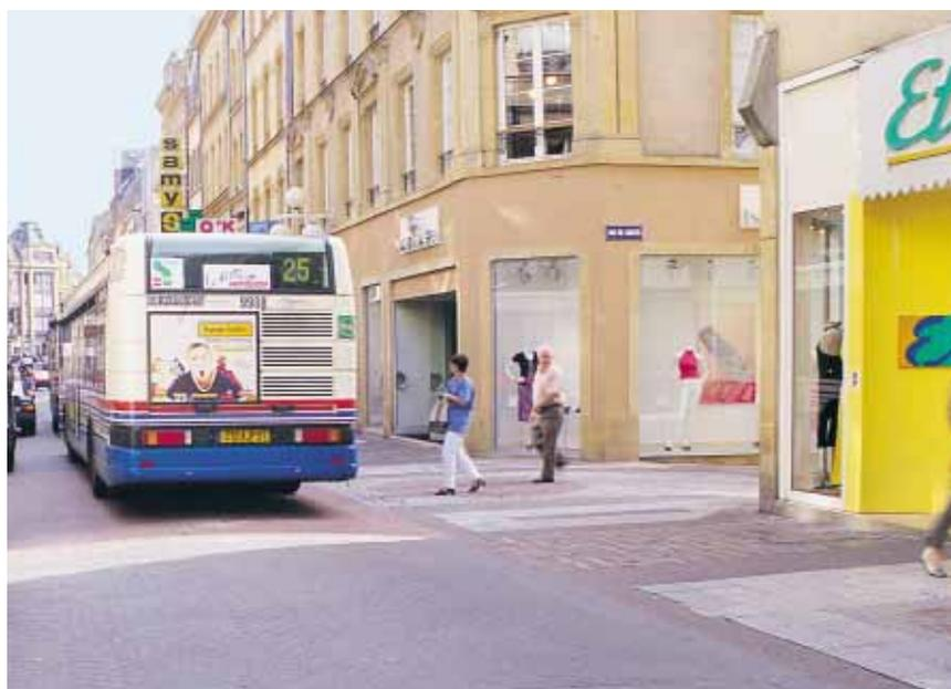
▲ Metz : la rue des Clercs et la rue Serpenoise supportent respectivement un trafic de 161 et 289 bus par jour, ce qui impliquait le recours aux chaussées en béton pour ralentir l'usure dans le temps.
