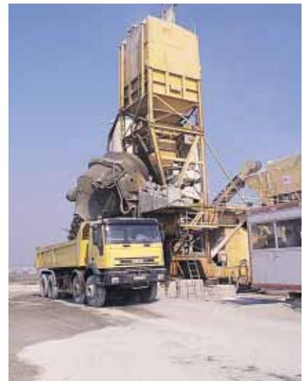
▲ La centrale est configurée sur ce chantier pour fournir 150 à 180 m<sup>3</sup>/h de façon discontinue – alors qu'elle pourrait atteindre 350 m<sup>3</sup>/h avec une configuration légèrement différente par montage d'un pré-malaxeur –, gâchées de 7 m<sup>3</sup>, afin de répondre aux à-coups des travaux.
