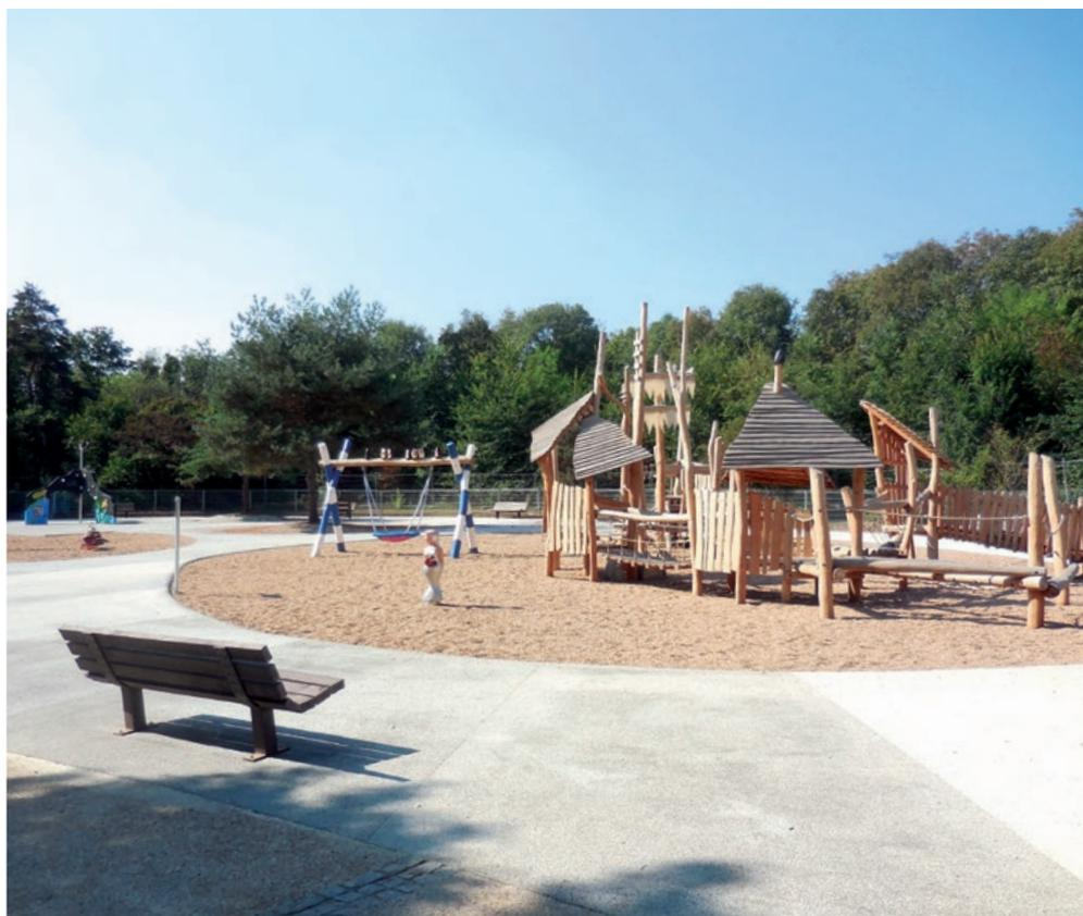
// L'une des deux aires de jeux rénovées, avant réouverture au public. Au total, 112 t de ciment Calcia (Pro Technocem 32,5 CEM II B – M (S-LL) Calcia Gargenville bio) et 550 t de gravillons ont été utilisées pour réaliser 3 900 m<sup>2</sup> de béton drainant.
