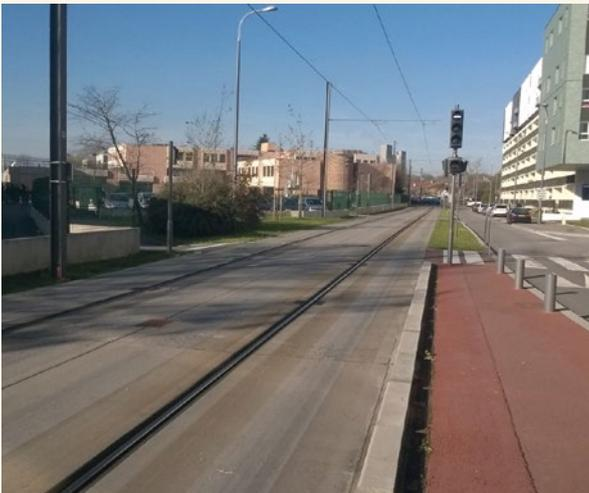
La couche de roulement utilise un béton routier BC5 de 23 cm d'épaisseur.
