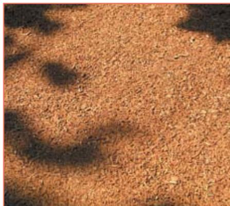
Lisses : les granulats 4/10 du béton drainant proviennent de billons d'épicéas des Vosges qui ont été déchiquetés, broyés, calibrés et tamisés.
