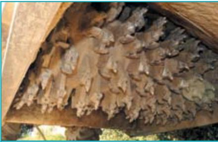
Grâce au rotor de malaxage, les matériaux, le liant et l'eau sont intimement mélangés sur 35 à 40 cm d'épaisseur.
