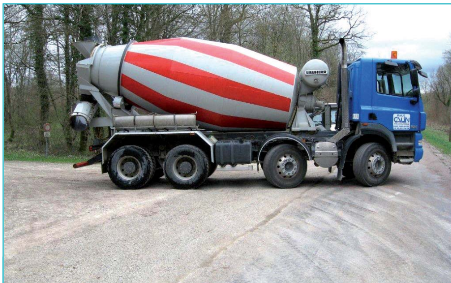
Une fois sa prise achevée, le MACES supporte parfaitement le passage des poids lourds.
