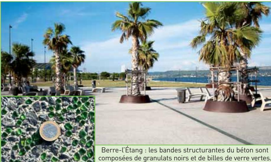
Berre-l'Étang : les bandes structurantes du béton sont composées de granulats noirs et de billes de verre vertes.
