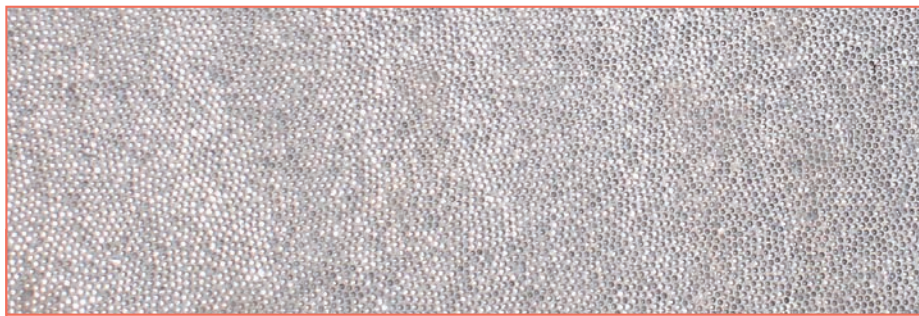
Gros plan sur les microbilles de verre incluses dans la surface du béton.
