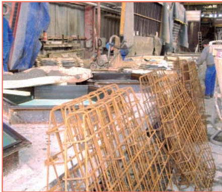
Robustes, les dalles préfabriquées en usine sont fortement ferrillées.
