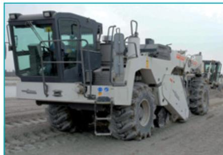
On valorise le sol en place en lui incorporant un liant et en les mélangeant pour obtenir un matériau homogène.
