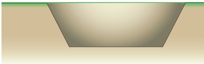
Terrassement de la tranchée en fouille talutée
