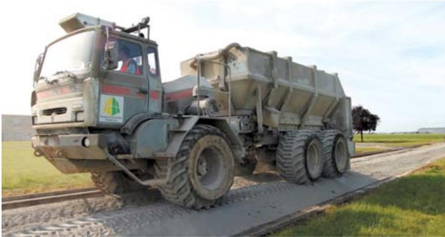
Épandeur moderne doté d'un système de dosage volumétrique associé à une trémie de pesage.
