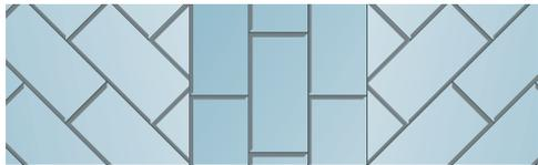
**Figure 22 : caniveau réalisé par 3 pavés adjacents.**
