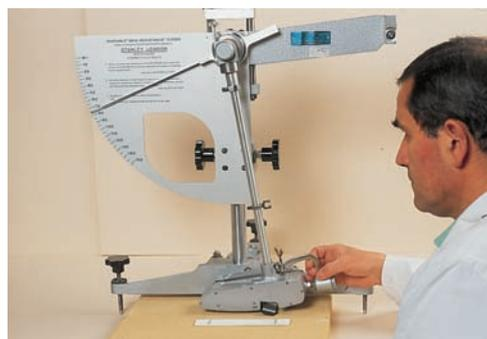
*Essai SRT: pendule « Skid Resistance Test ».*
