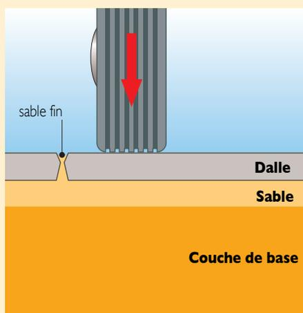
La pose des dalles, s'effectue à l'aide d'un engin de capacité suffisante, équipé soit d'un palonnier muni de clés de manutention, soit de ventouses. Entre les dalles, le joint d'environ 5 mm est rempli de sable fin, à l'avancement et en fin de chantier.
