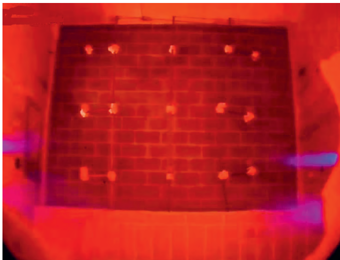
Figure 10. Essai de résistance au feu d'un mur en blocs béton réalisé au Cerib (au bout de quatre heures d'essai, la température du four est de 1 150 °C) : vue à l'intérieur du four pendant l'essai (© Cerib – Laboratoire Prométhée).
