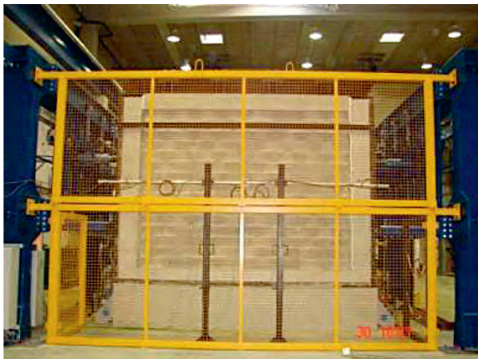
Figure 10. Essai de résistance au feu d'un mur en blocs béton réalisé au Cerib (au bout de quatre heures d'essai, la température du four est de 1 150 °C) : vue à l'intérieur du four pendant l'essai (© Cerib – Laboratoire Prométhée).
