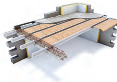
Figure 40. Poutres plates à faibles retombées (© FIB).
