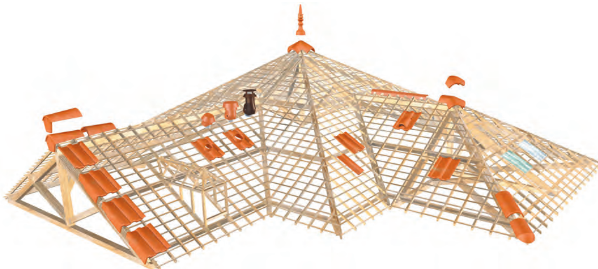
Figure 47. Toiture complète en tuiles en béton à emboîtement et glissement « double romane » et ses accessoires (© FIB).
