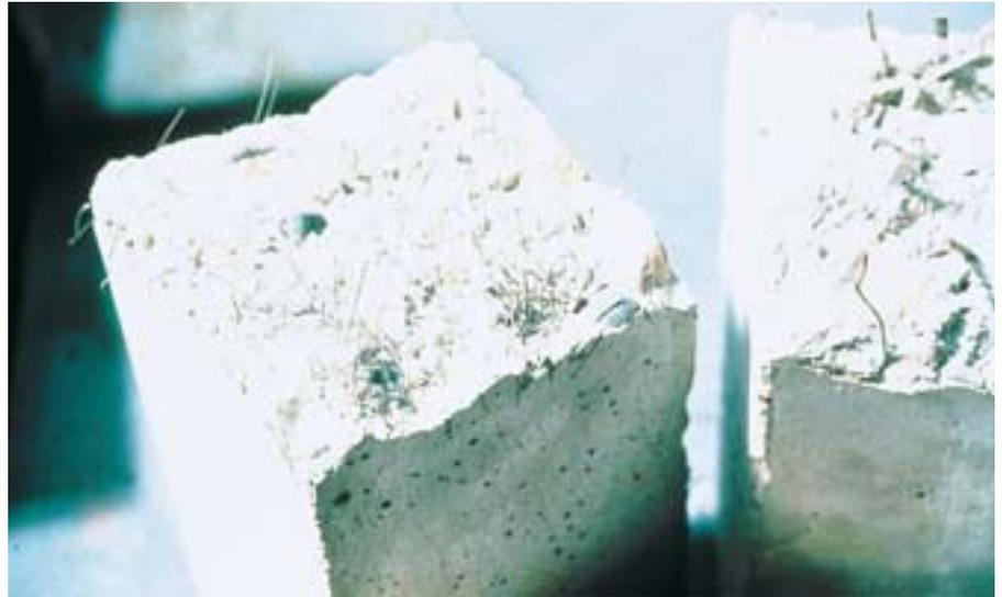
microfibres avec des macrofibres (fibres courtes et fibres longues). Cette tendance se développe dans le cadre des bétons ultraperformants.
