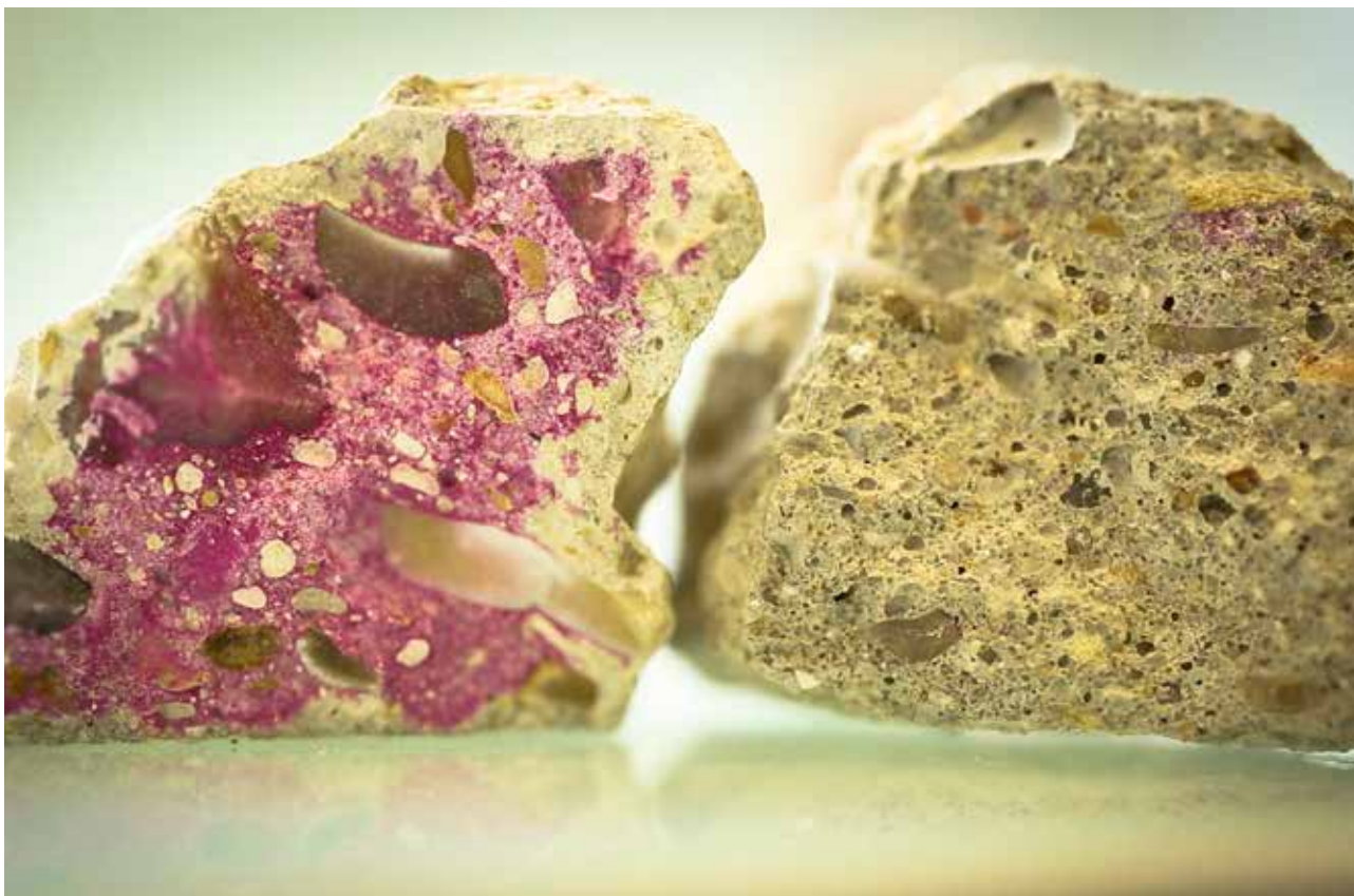
Béton de déconstruction concassé. A gauche, laissé à l'air libre, le rose est la partie non-carbonatée ; à droite, après carbonatation artificielle, le béton est carbonaté à cœur.
