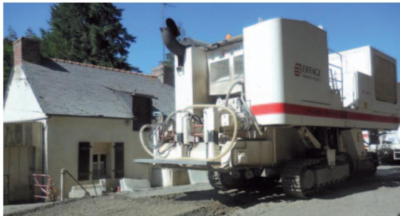
Vue de l'arrière de l'ARC 1000 d'Eiffage. Cette véritable « centrale mobile » décohesionne l'ancienne chaussée « transversalement et verticalement », mélange le liant avec le matériau en place avant l'homogénéisation de l'ensemble des constituants à l'aide d'un malaxeur intégré.
